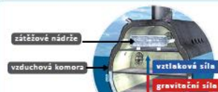
obrázek č. 7 - Ponorka při klesání - příčný řez
